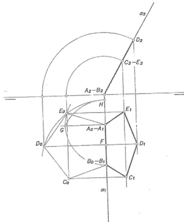
Dibujar la planta y el alzado de un hexágono regular contenido en el plano dado y apoyado sobre el segmento AB.
