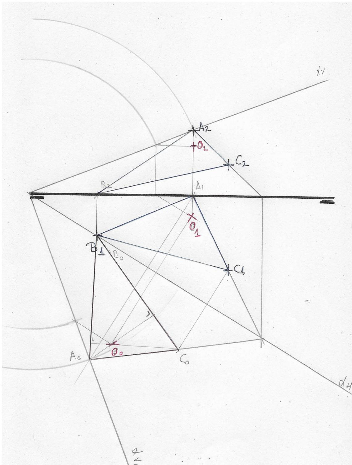
Dibujar las proyecciones diédricas de un cuadrado conocidas las proyecciones de un vértice P, y las proyecciones de las rectas que soportan dos lados opuestos: r y s.
